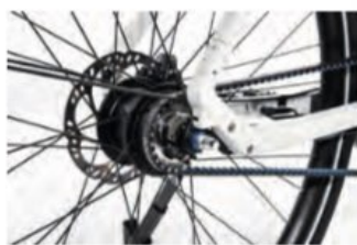
Top Kombi: 8-fach-Getriebe mit Schaltunterbrechung & Riemen.
